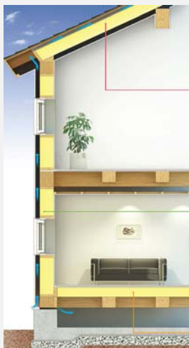
筋かいと一体の断熱壁
